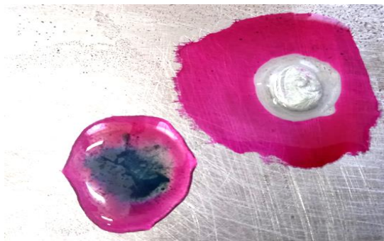
Рисунок 1 – Качественные реакции. Коррозия под каплями воды
