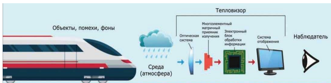
Рисунок 2 – Схема работы тепловизора
